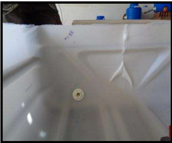
Figure 38 : Trou du trop-plein pour les bacs IBC
