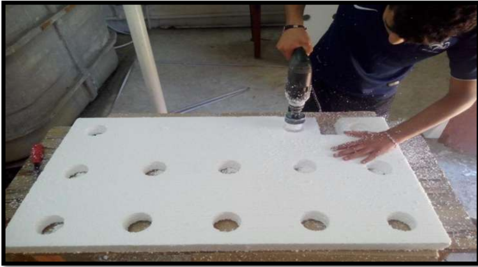
Figure 48 : Préparation des radeaux en polystyrène avec 15 trous
