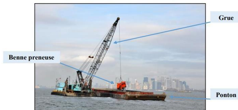
Figure 56 : Drague à benne preneuse ( Gardner, 2010 )
