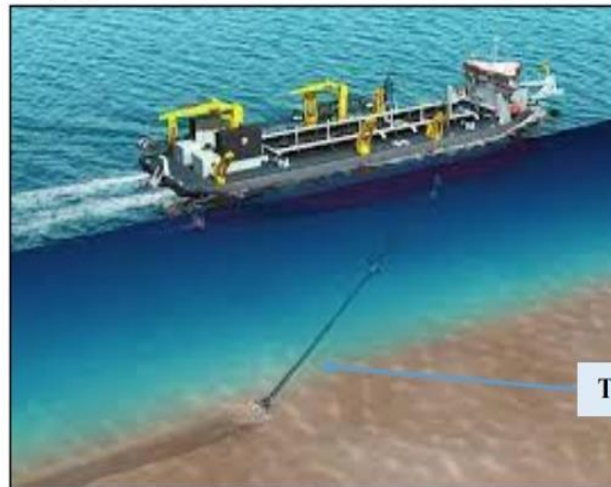
Figure 57 : Drague aspiratrice en marche (IADC, 2014)
