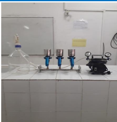
Figure 11 : Dispositif de filtration de marque Millipore®.
