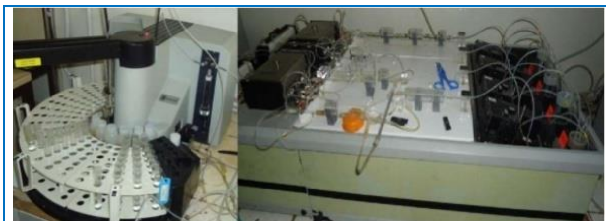
Figure 15 : Auto Analyser San Plus (SKALAR®, 1998).
