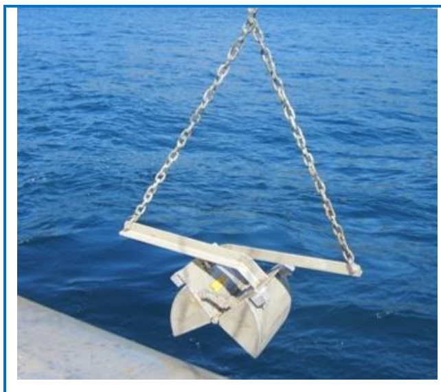
Figure 09 : Benne de prélèvement du sédiment de type Van-veen
