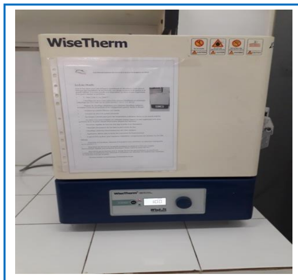
Figure 10 : four à moufle de type WiseTherm
