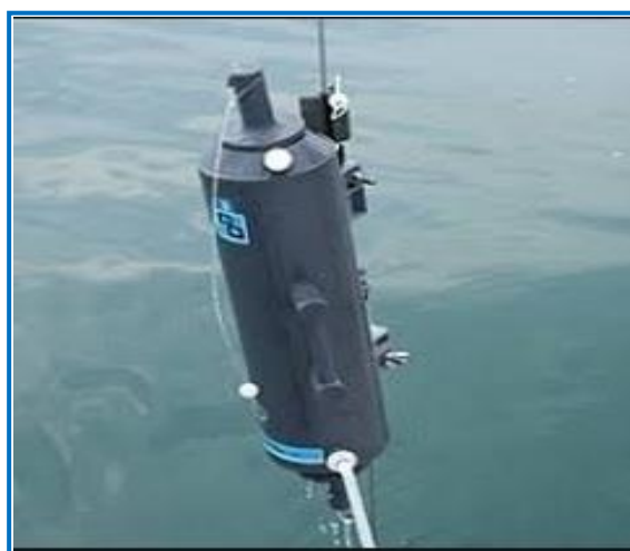
Figure 08 : bouteille de prélèvement de type NISKIN
