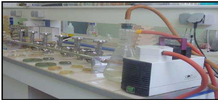
Figure 18 : Dispositif de l'appareil de filtration sur membrane.
