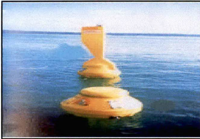
Figure II.2 : Les bouées dérivantes sont équipées d'une ancre flottante, ce qui donne un filin supportant différents capteurs entre la bouée et l'ancre (capteurs de température de la mer et capteurs de salinité, capteurs de pression pour connaître la profondeur où sont effectuées les mesures ..., en surface et à différentes profondeurs ...).
