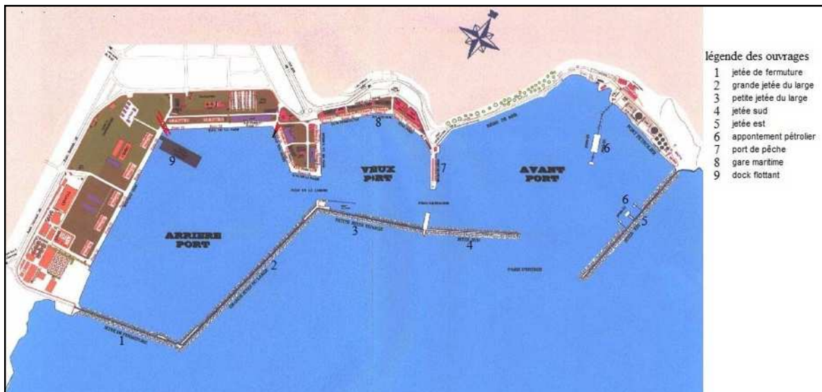
Figure 10 : Plan de masse et ouvrages du port de Bejaia (Entreprise Portuaire de Bejaia, 2007).
