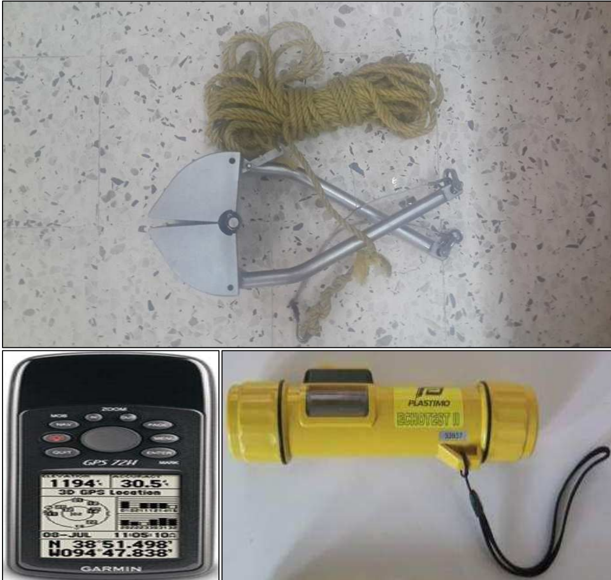
Figure 4.2 : GPS, Echosondeur et Benne preneuse de type « Van-Veen ».
