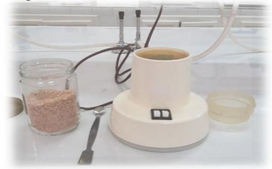
Figure 6. Broyage de la matière première
