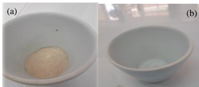
Figure 31 : Déminalisation du chitosane, a. creuset avant passage au four à moufle. b. Creuset après passage au four à moufle.
