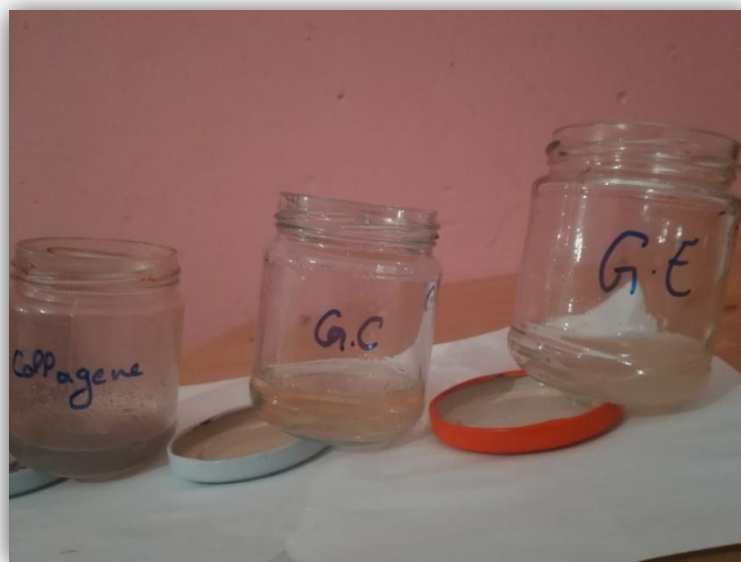
Figure30 : gélification de gélatine commerciale et collagène
