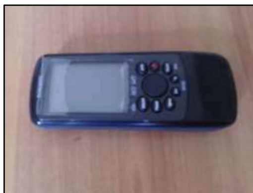
Figure 22 : GPS Garmin utilisé pour la géolocalisation (précision de l'ordre de 5m)
