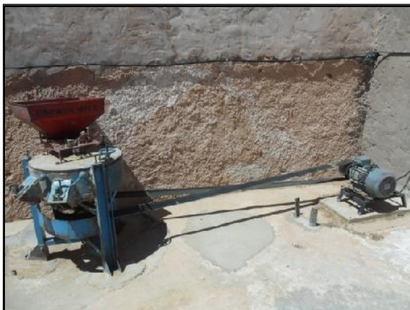
Figure 10 : Broyeur à marteau
