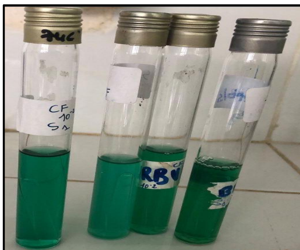
Figure III.16. Aspect des coliformes sur BLBVL
