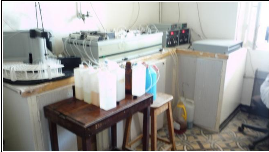
Photo AII.1. Auto-analyser SAN Plus Système de marque SKALAR, 1998.
