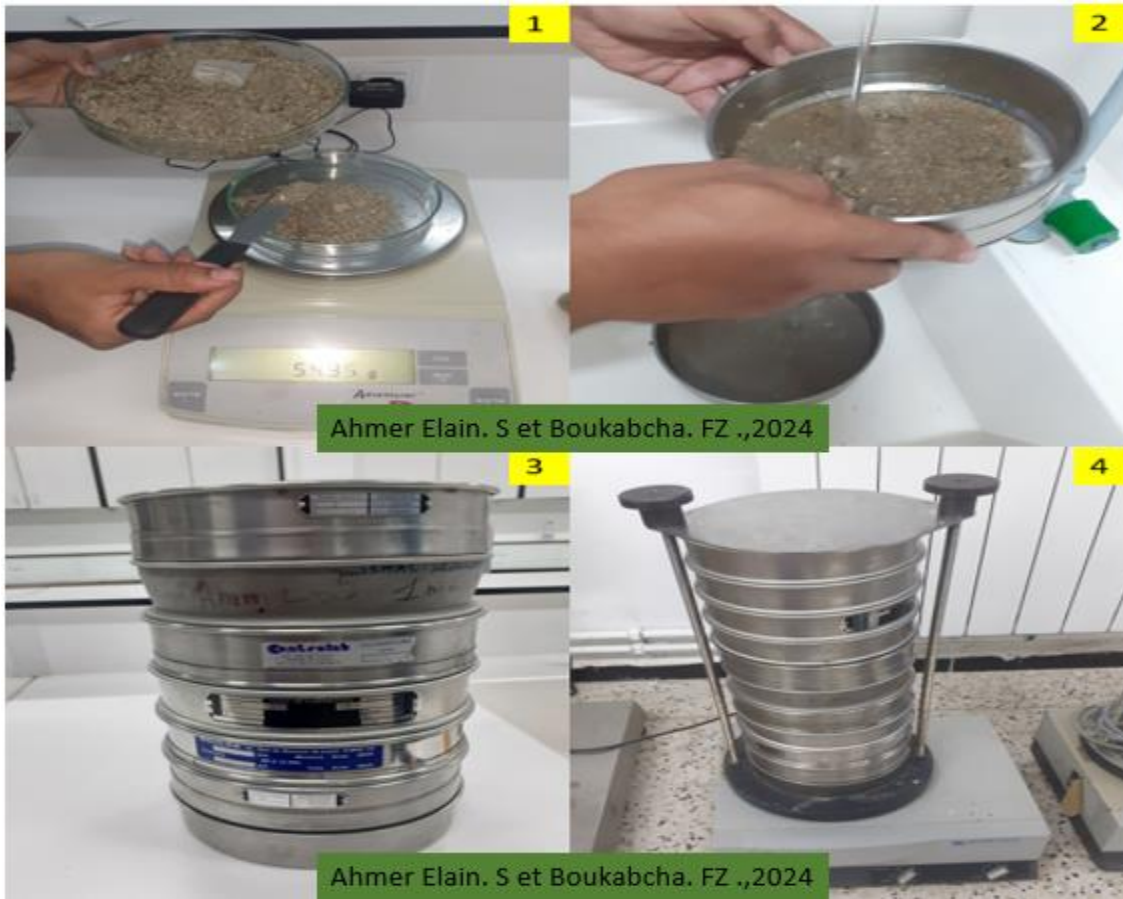
Figure 03 : 1/ le pesage de 200g 2/ le rinçage 3/ préparation de la série de tamisage 4/ l'opération de tamisage
