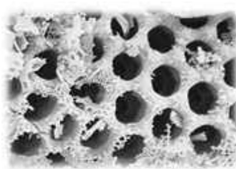
Figure. 3a : Aspect de la texture de diatomite. Figure. 3b : Aspect de la structure des pores.
