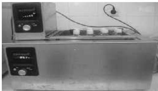
Figure. 11 : Bain thermostaté muni d'un agitateur. Figure. 12 : Echantillons mis dans le batch.
