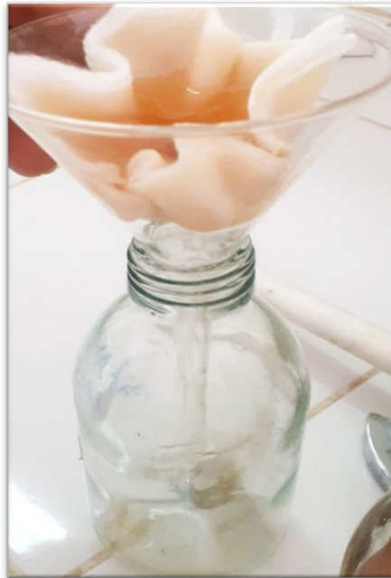
Figure 9. L'étape de filtration sur papier filtre ( 0.45\mu\text{m} ) des gazes.
