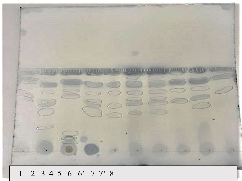
Figure 26. Résultats de la chromatographie du système (chloroforme /méthanol90/10 v/v) après la deuxième révélation par l'acide phosphomolybdique.
