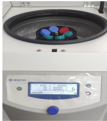
Figure 14 : Centrifugation de l'extrait algale
