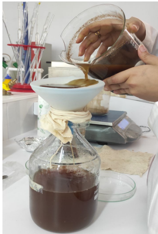
Figure 13 : Filtration de mélange
