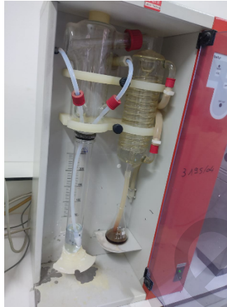
Figure 24 : Système de distillation de l'échantillon dans la méthode de Kjeldahl
