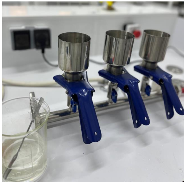
Figure 17. Rampe de filtration
