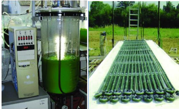
Figure 9. Systèmes modulaires de photobioréacteurs fermés pour la culture de Dunaliella salina (Zhang et Wang, 2015)
