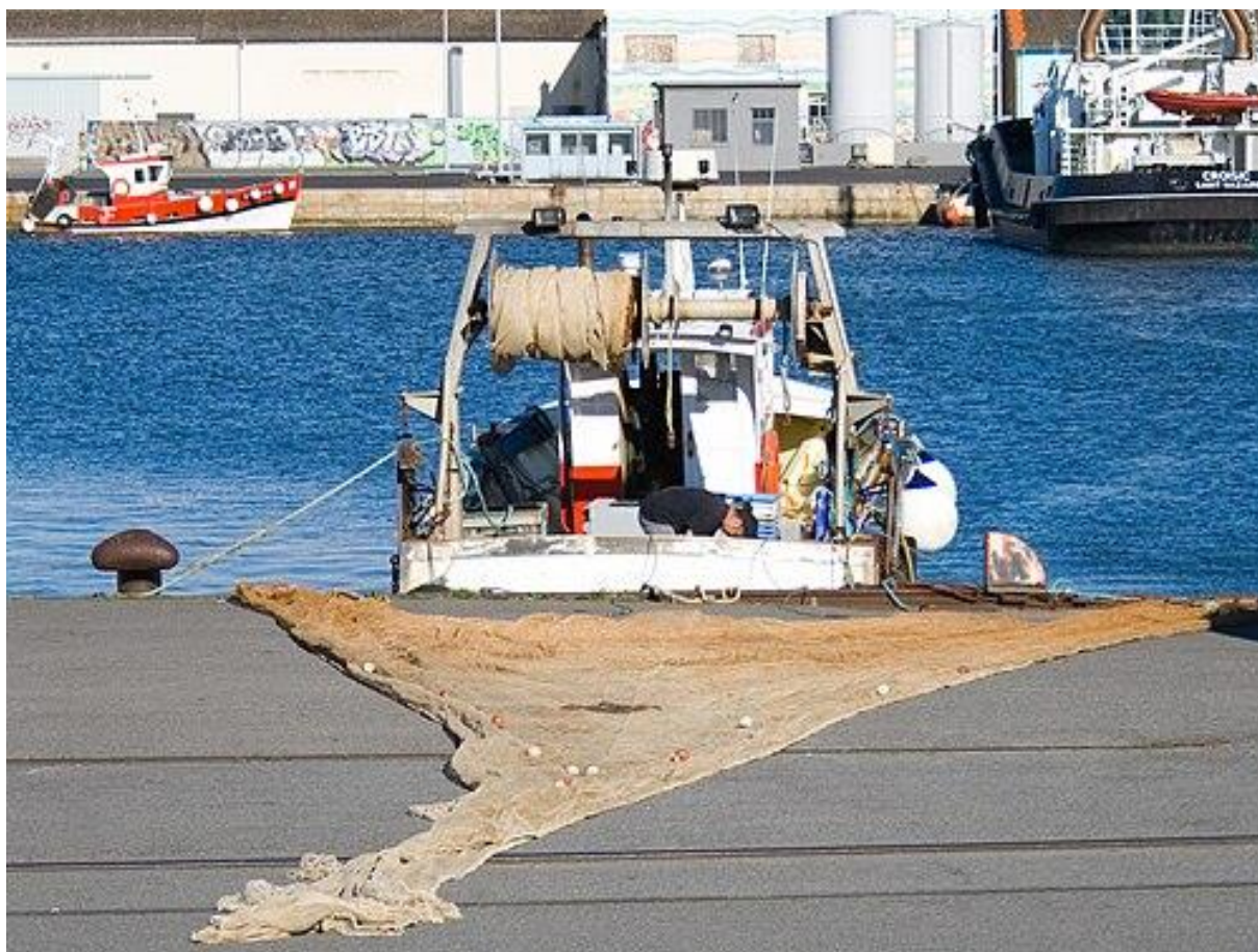
Figure I.6. Chalut étalé sur le quai, derrière le portique d'un chalutier ( https://fr.wikipedia.org/wiki/Chalut ).
