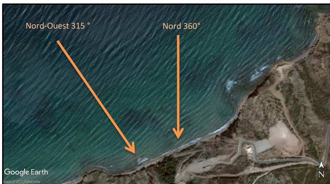
Figure II. 11: Direction des houles défavorables au niveau de la plage d'Ain Franine (Google Earth Pro, 2017).
