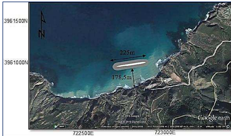
Figure VII. 2: Installation du brise-lame dans la plage d'Ain Franine.
