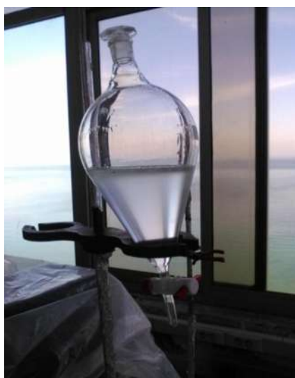
Figure III.3 : Extraction des hydrocarbures dans une ampoule à décanter
