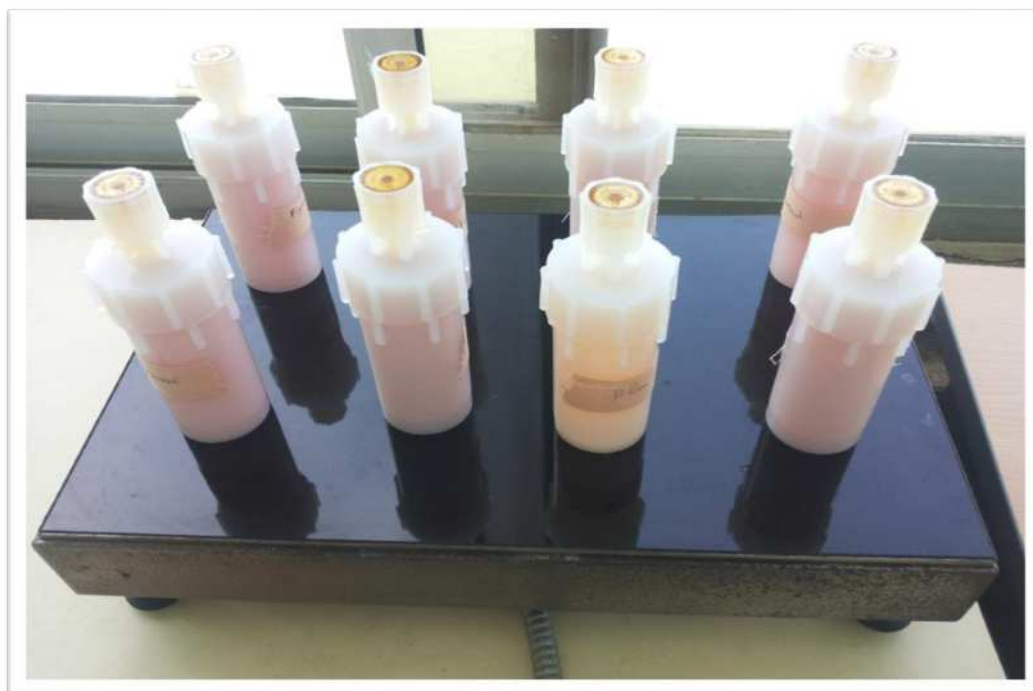
Figure 13 : Plaque chauffante à minéralisation.
