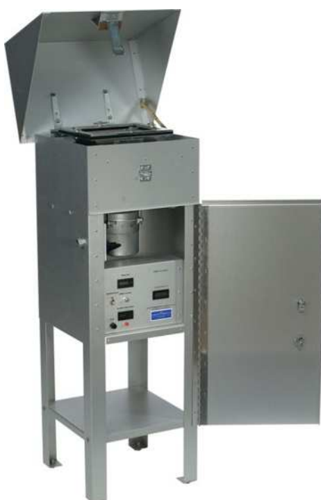
Fig. 12: Préleveur d'aérosols à débit moyen de 40\text{ m}^3/\text{h}
