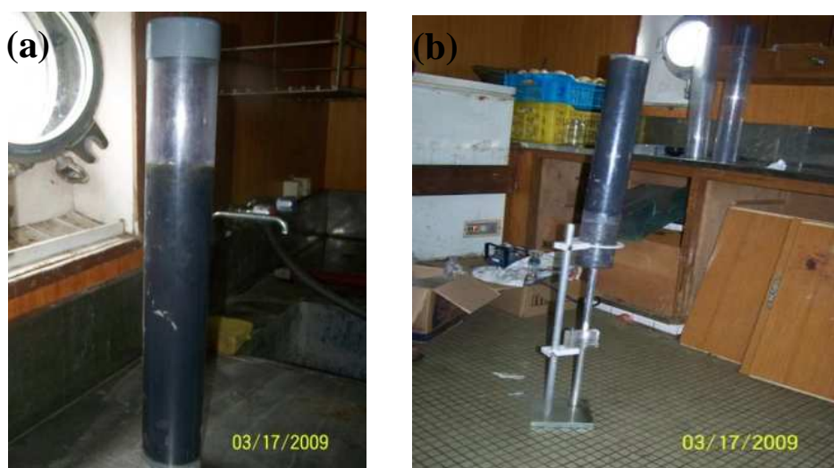
Fig.16 : a) Carotte récupérée dans un tube en PVC ; b) dispositif de sectionnement des carottes
