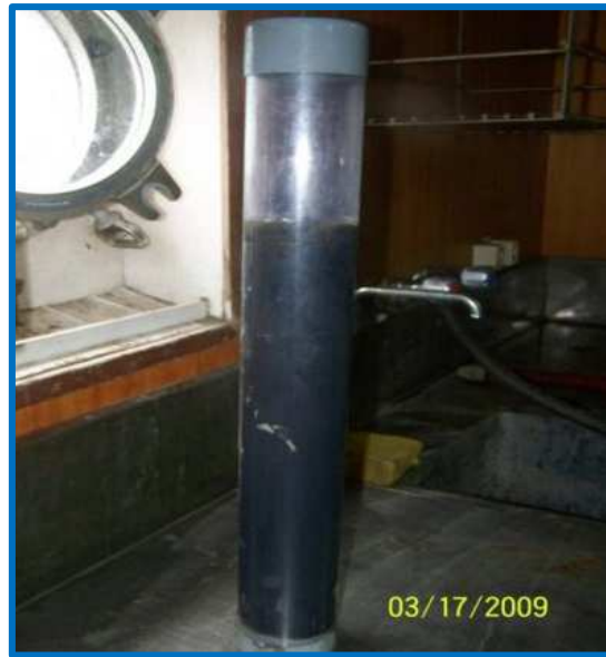
Figure 3 : Carotte récupérée dans un tube en PVC
