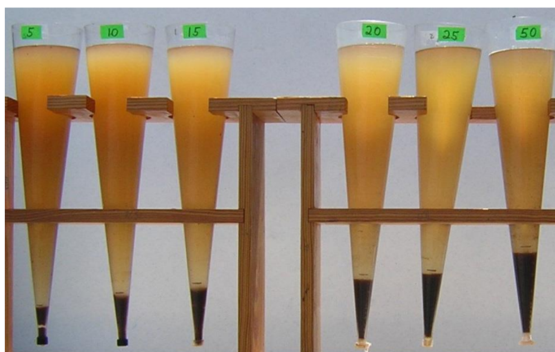
FIGURE IV.12 : Cônes Imhoff utilisés pour mesurer le biofloc (Hargreaves, 2013)
