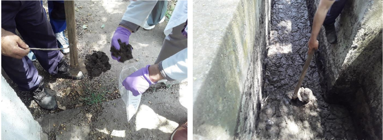
Figure 6 : Prélèvement de la boue de l'aérateur biologique à la station d'épuration de Koléa.
