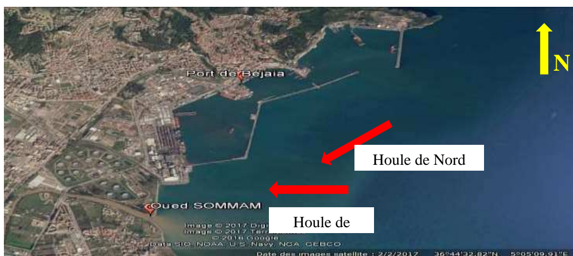
Figure II.6: Exposition du port aux différents secteurs de houle (Google Earth 2017).
