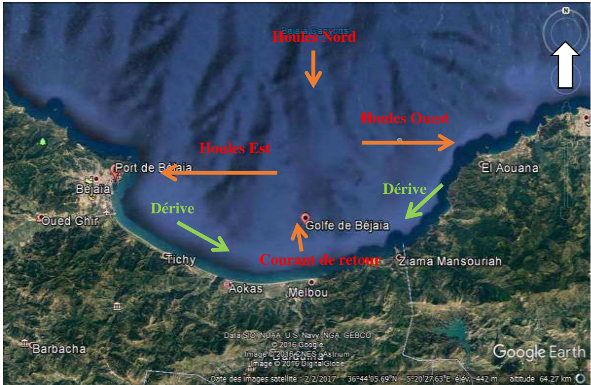
Figure II.9: Schéma probable de la dynamique sédimentaire dans la baie de Bejaia (Google Earth, 2017).
