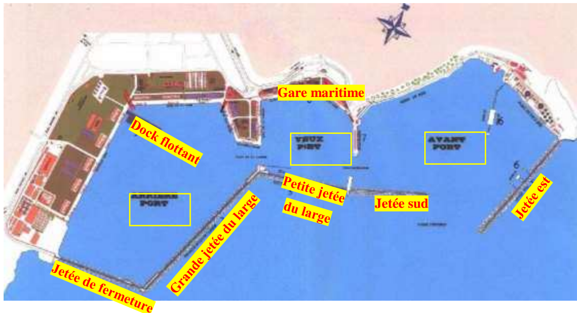
Figure II.2: Les ouvrages du port de Bejaia (Entreprise Portuaire de Bejaia, 2007).
