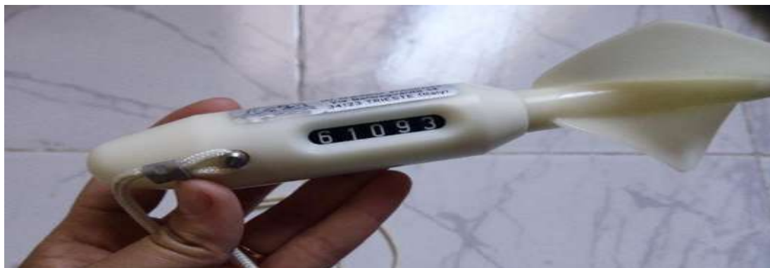
Figure 24 : Débitmètre mécanique de marque TALASSA (ENSSMAL).
