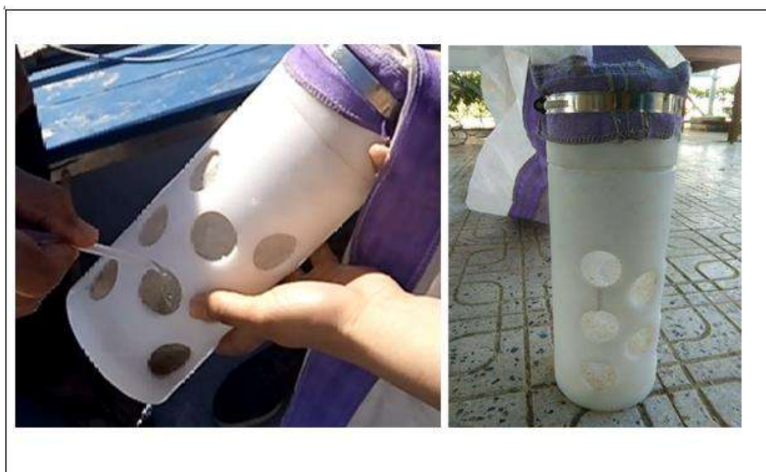
Figure 23 : Collecteur en PVC du filet Manta (ENSSMAL).
