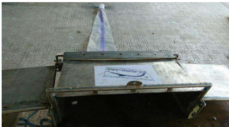
Figure 20 : Structure métallique de filet Manta (ENSSMAL).
