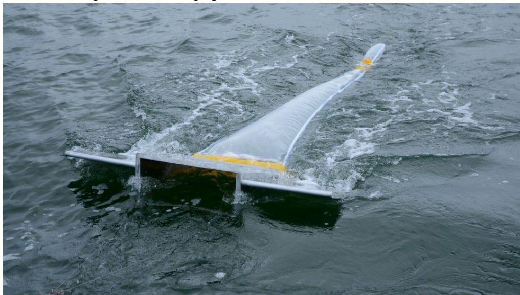
Figure 17 : Photographie montrant déploiement du chalut Manta en mer.
